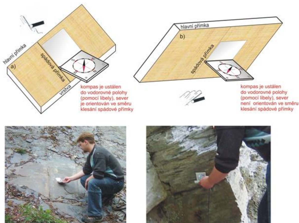
Obr. 6.11 Schematický náčrt měření směru úklonu roviny A\phi pomocí geologického kompasu
