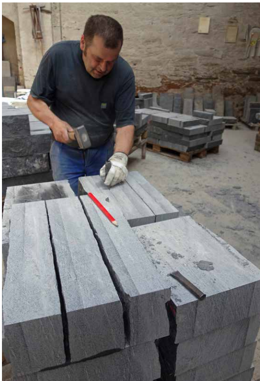
Abb. 17 | Spalten der Fruchtschieferplatten von Hand im Natursteinwerk Theuma GmbH (2021).
