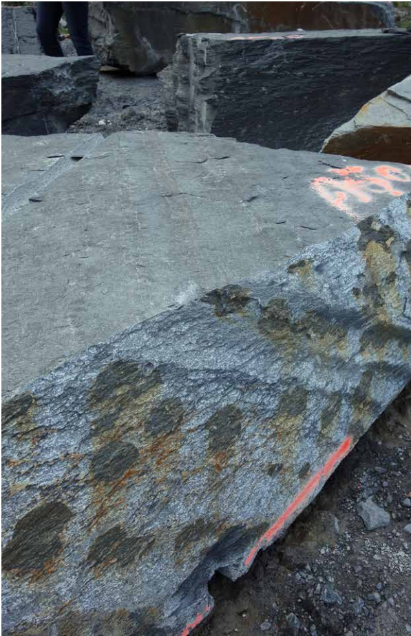
Abb. 4 | Rohblock im Steinbruch Theuma mit typischer Transversalschieferung: Die Schieferungsrichtung verläuft parallel zur Blockoberseite, die Schichtungsrichtung (kenntlich durch Farbwechsel auf der Schieferungsfläche und wellige Textur auf der Kluftfläche vorn) im spitzen Winkel dazu. Die senkrecht zur Schieferung orientierte Kluftfläche zeigt fleckige Beläge mit Brauneisen.
