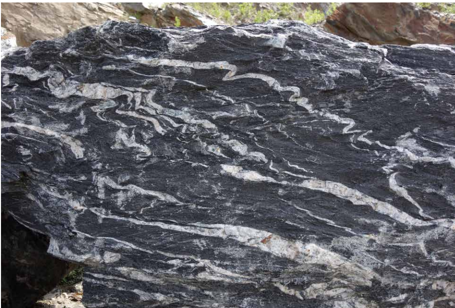
Abb. 5 | Quarzschlieren, die durch die tektonische Deformation des Gesteins verfaultet wurden, in einem quarzreichen Fruchtschiefer (nicht zur Werksteinbearbeitung geeigneter Block im Steinbruch Theuma).
